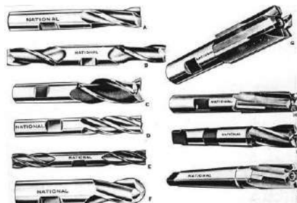
Gambar. 37. Pisau Jari ( End Mill Cutter) (A) Dua mata satu ujung, (B) Dua mata dua ujung, (C) Tiga mata satu ujung, (D) Mata ganda satu ujung, (E) Empat mata dua ujung, (F) Dua mata ujung bulat,
